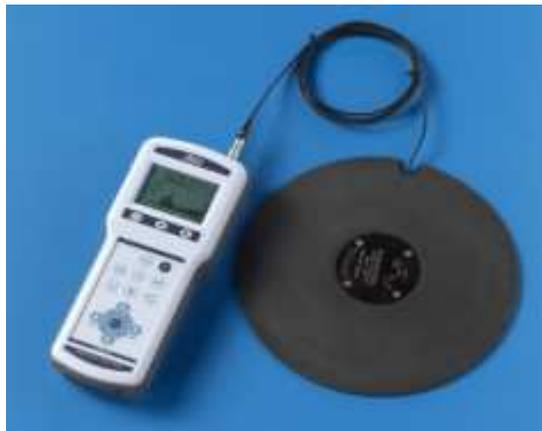
Il D.Lgs 81/2008, al Titolo VIII, capo III art. 201 ne definisce i valori limite di esposizione e i valori di azione. Lo strumento per la misurazione delle vibrazioni è l'Accelerometro. In base alla valutazione dei rischi di cui all'articolo 202, quando sono superati i valori d'azione, il Datore di Lavoro elabora e applica un programma di misure tecniche o organizzative volte a ridurre al
